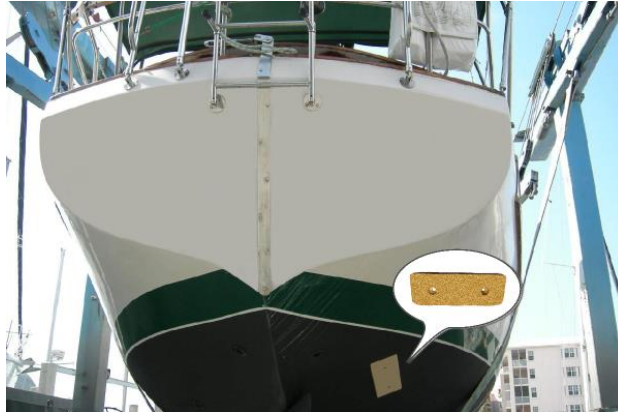
Şekil 3 : Tekneler için özel olarak geliştirilmiş “GR-MARINE” topraklama plakası
